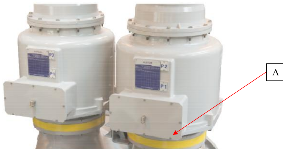
Рисунок 1 – Фотография общего вида трансформаторов тока В105-СТ Место пломбировки от несанкционированного доступа (А)
