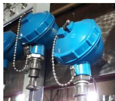
Рисунок 12 – Преобразователи давления первичные ЗОНД-10-ИД. Вид внешний
