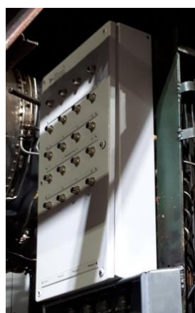
Рисунок 3 – Шкаф приборный измерения давлений № 1 и шкаф сканеров температур. Вид внешний
