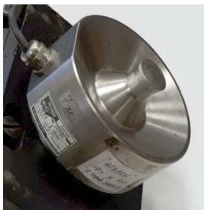
Рисунок 9 – Преобразователь первичный силы от тяги ТЕНЗО-М М70К-С3. Вид внешний
