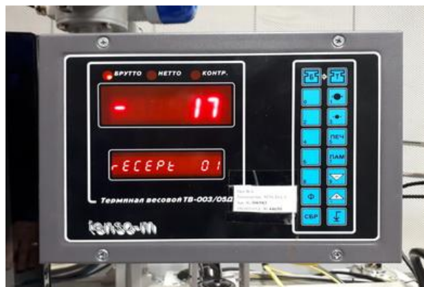
Рисунок 10 – Терминал весовой ТЕНЗО-М ТВ-003/05Д. Вид внешний
