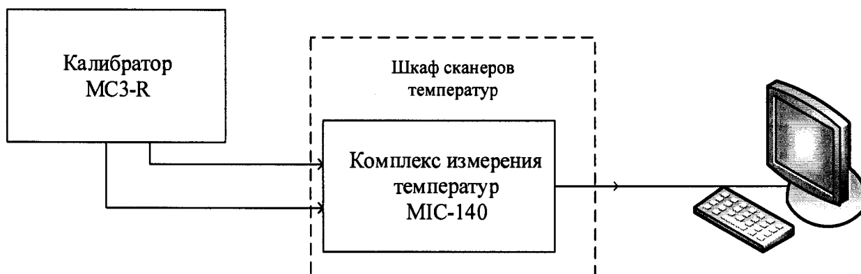
Рисунок 144 – Схема поверки ИК напряжения постоянного тока
