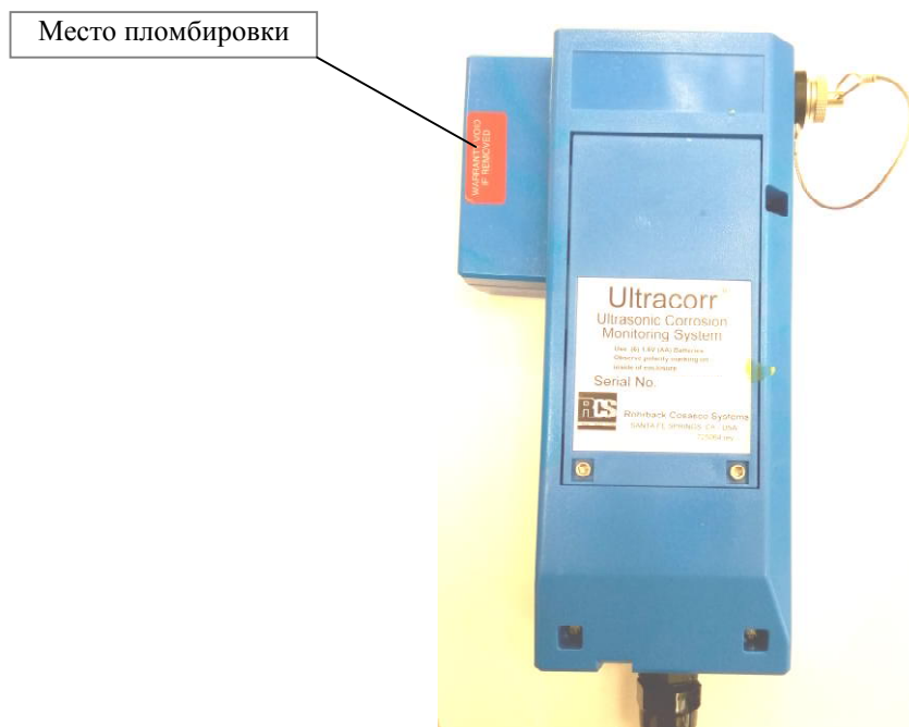
Рисунок 2 – Схема пломбировки от несанкционированного доступа
