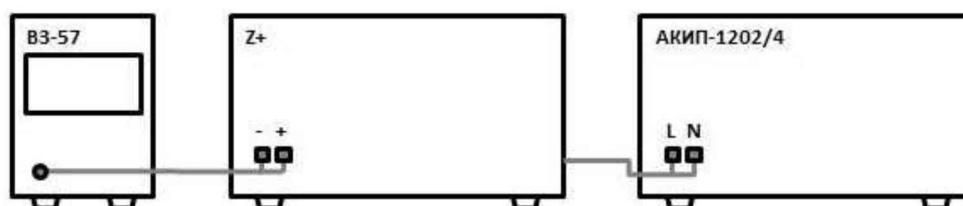
Рисунок 4 – Схема соединения приборов при определении уровня пульсаций выходного напряжения
