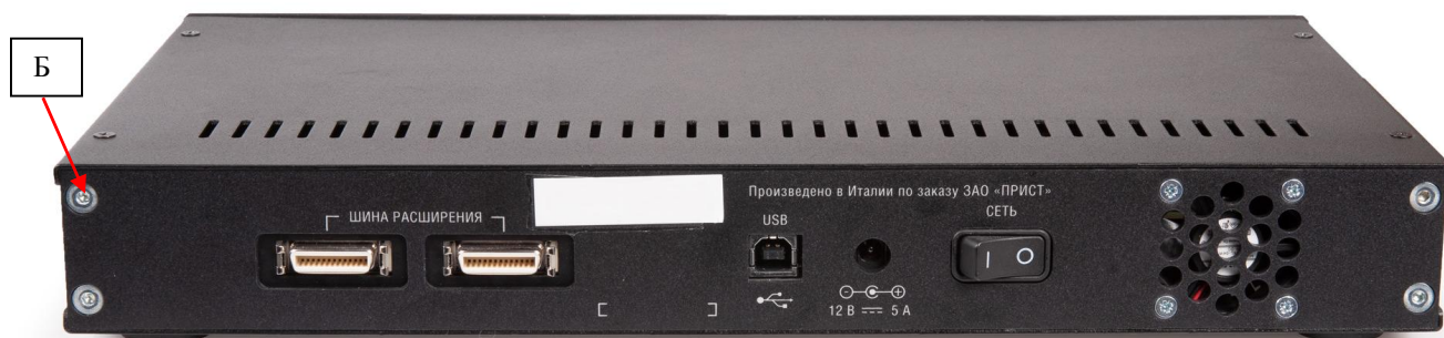
Рисунок 4 – Вид задней панели генераторов АКПП-3405 Arg-Студия и место опломбирования от несанкционированного доступа (Б)
