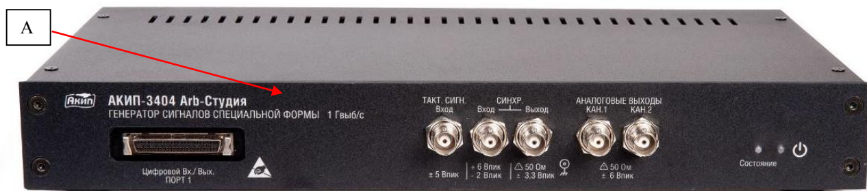
Рисунок 1 – Общий вид генераторов АК ИП-3404 Arb-Студия и место нанесения знака утверждения типа (А)
