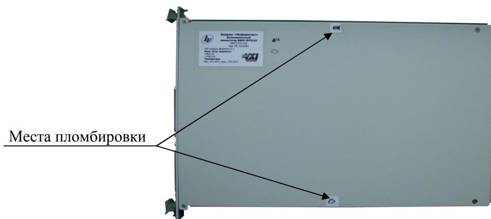
Рисунок 2 – Схема пломбировки от несанкционированного доступа функционального модуля системы
