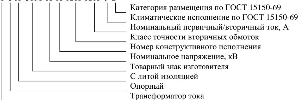
Рисунок 3 – Структура условного обозначения трансформаторов ТОЛ-ЗТМ
