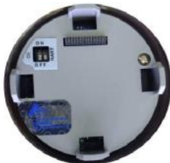
Рисунок 3 – внутренняя гарантийная пломба под панелью управления с ЖКИ
