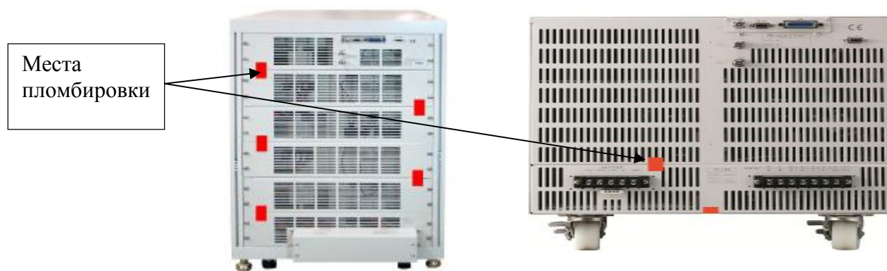
Рисунок 2 – Схема пломбировки источников от несанкционированного доступа
