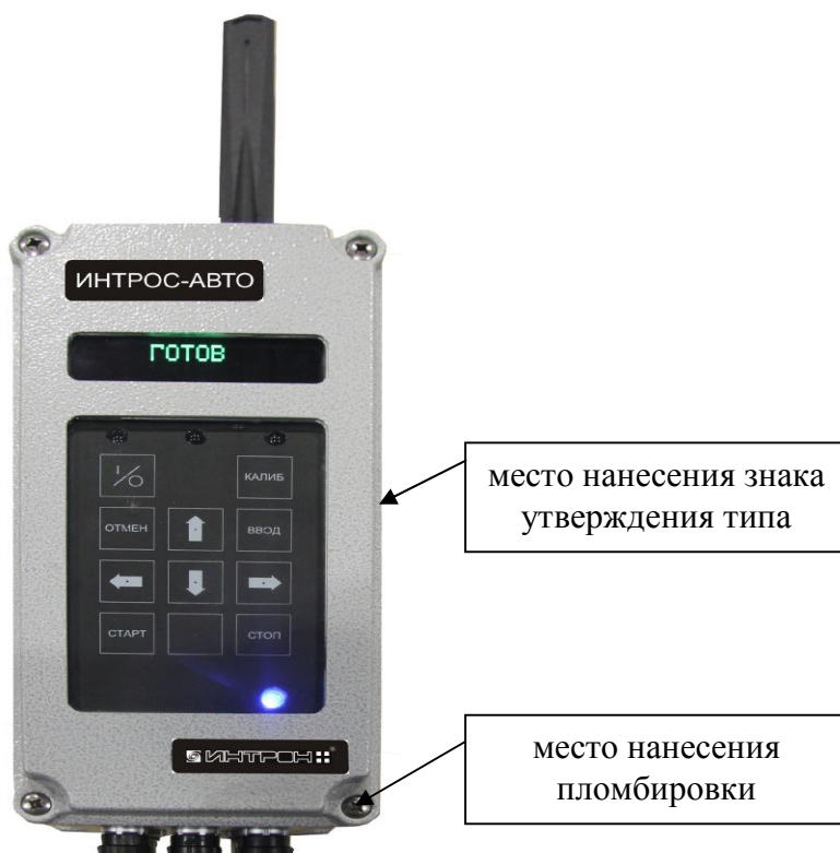
Рисунок 1 - Общий вид блока управления и индикации (БУИ), место нанесения знака утверждения типа и место нанесения пломбировки
