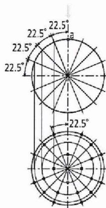
Рисунок 1. Точки касания на сфере для определения допустимой абсолютной погрешности измерительной головки, МРЕ<sub>Р</sub>
