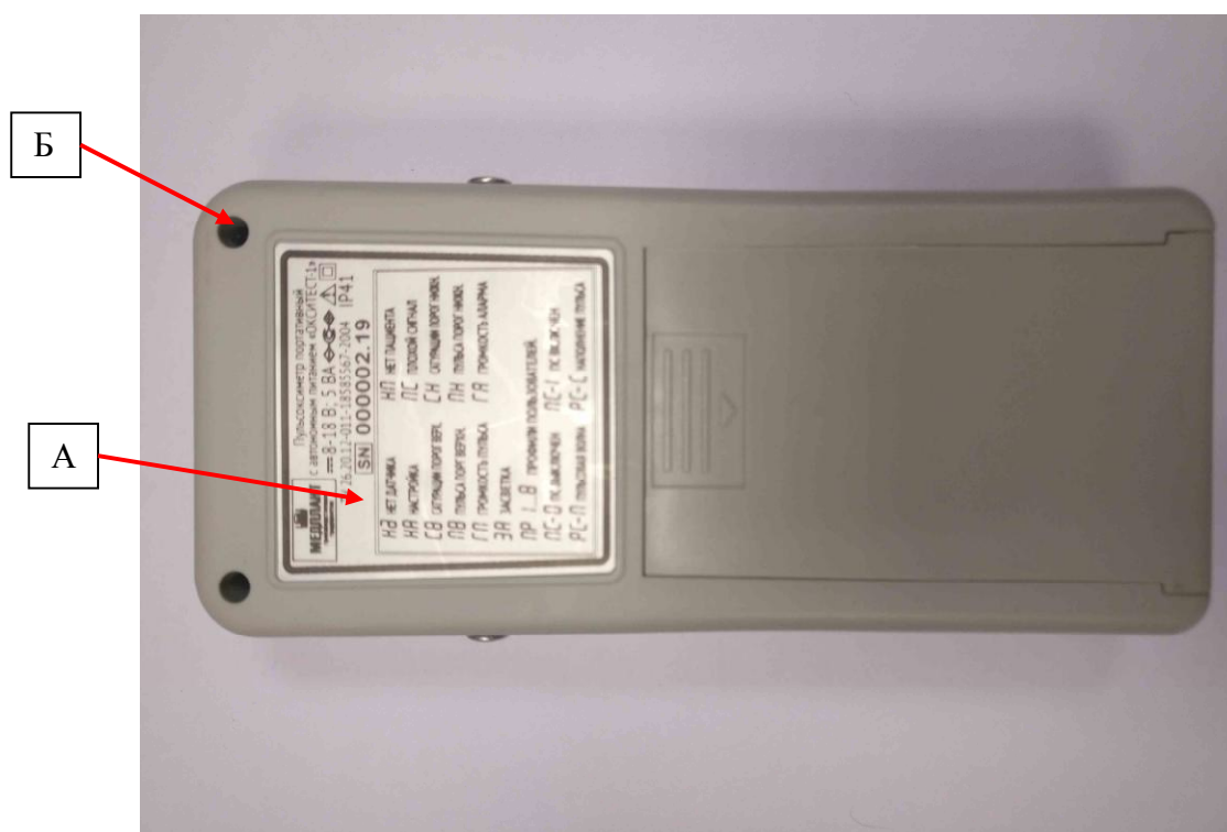
Рисунок 2 – Схема нанесения знака утверждения типа (А) и схема пломбировки от несанкционированного доступа (Б)
