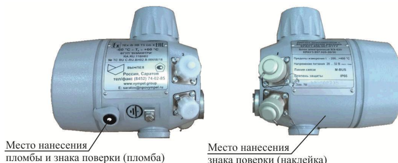
Рисунок 2 – Схема пломбировки от несанкционированного доступа и места нанесения знаков поверки
