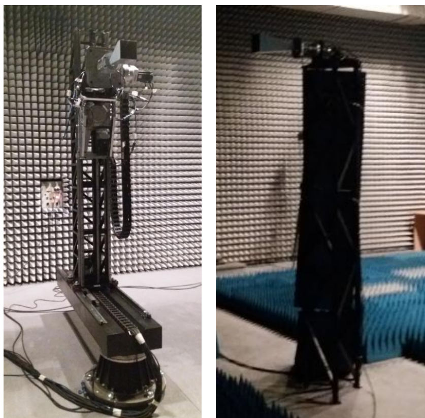
Рисунок 2 – Общий вид опорно-поворотного устройства PS-AZ-SL-EL-PL-60 (слева) и одноординатного поворотного устройства PS-AZ-10 (справа)
