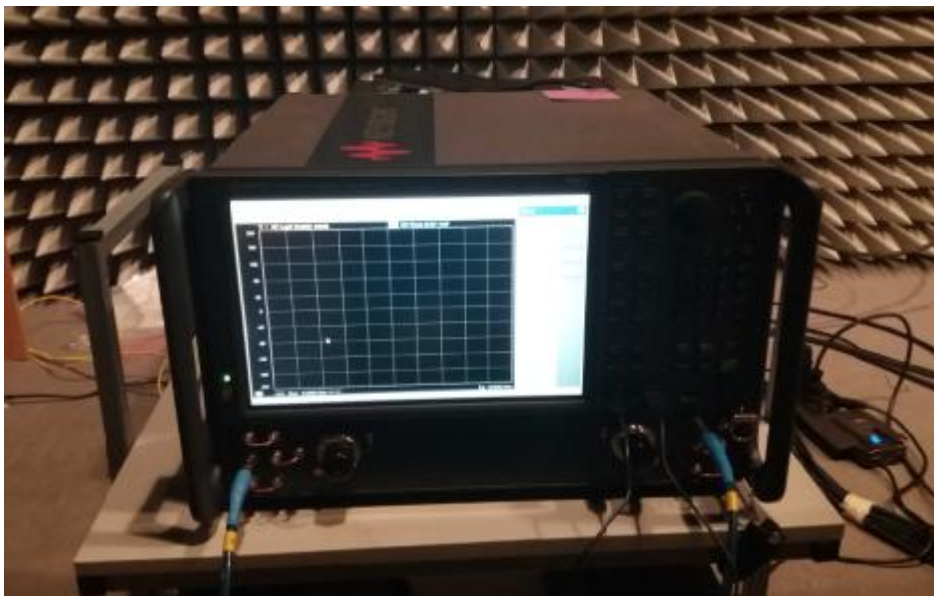
Рисунок 1 – Общий вид векторного анализатора цепей N5234A
