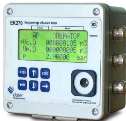
Рисунок 1 – Общий вид корректора объема газа ЕК270
