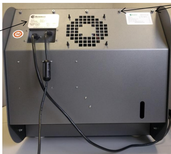
Рисунок 3 – Схема пломбировки от несанкционированного доступа, обозначение места нанесения знака поверки
