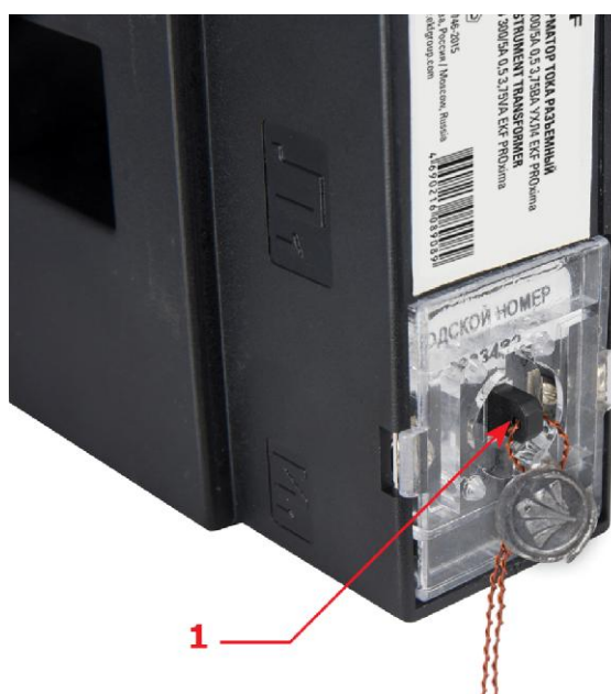
Рисунок 3 – Вид трансформаторов снизу 1 - Место навешивания пломбы с оттиском знака поверки
