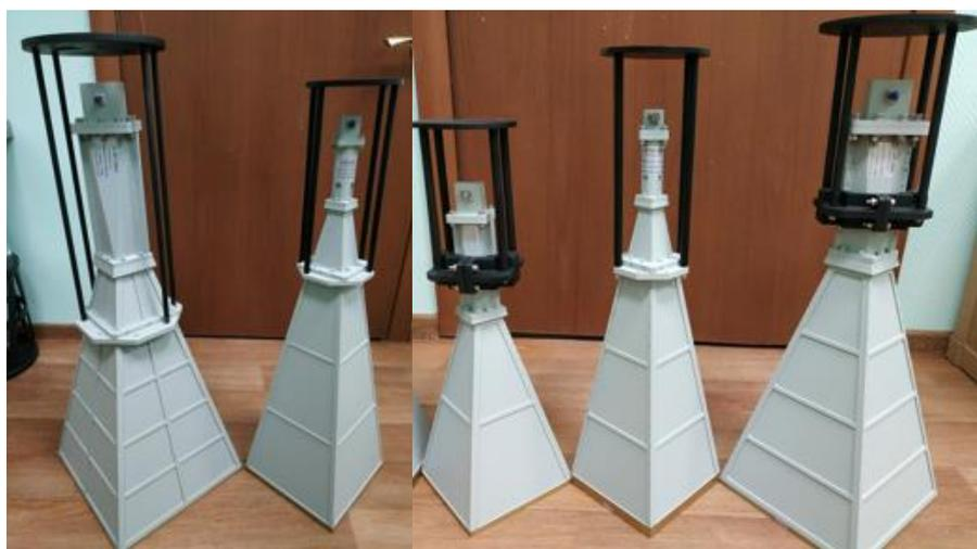
Рисунок 7 – Измерительные антенны (слева направо) LB-DG-229-20-C-SF, LB-DG-90-25-C-SF, LB-DG-112-20-C-SF, LB-DG-62-25-C-SF и LB-DG-159-20-C-SF
