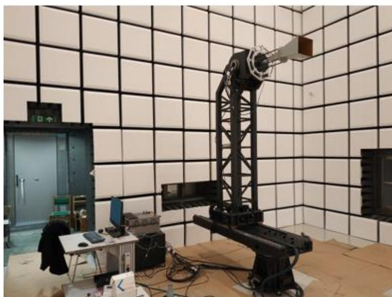
Рисунок 3 – Общий вид прецизионного 4-х координатного ОПУ
