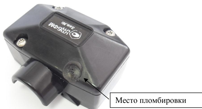
Рисунок 1 – Общий вид сигнализатора метана, совмещенного со светильником головным малогабаритным СГМ «Исеть», и схема пломбировки от несанкционированного доступа
