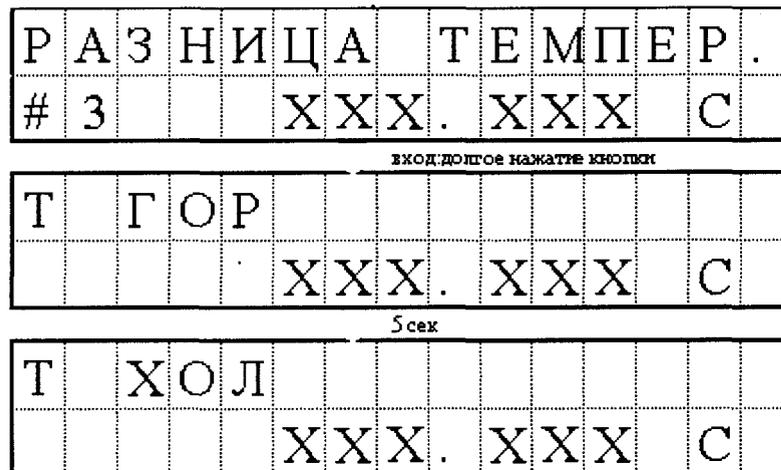
Рисунок 3.4.2-Меню отображения температуры с первичных преобразователей на подающем и обратном трубопроводе.
