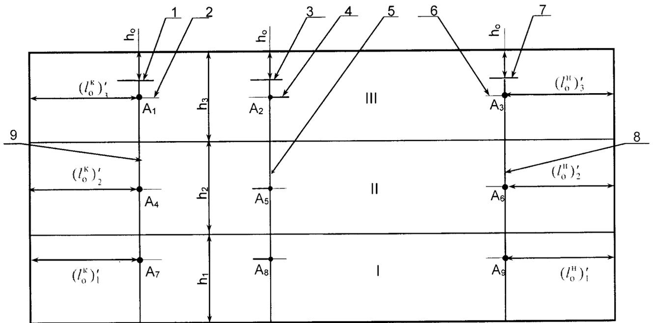
1, 2, 3, 4, 6, 7 – горизонтальные отметки; 5, 8, 9 – вертикальные линии;  $h_o$  – расстояние между отметками 1, 3, 7 и местом стыка переборки с палубой судна;  $A_1-A_9$ ,  $B_1-B_9$  – точки измерений.
