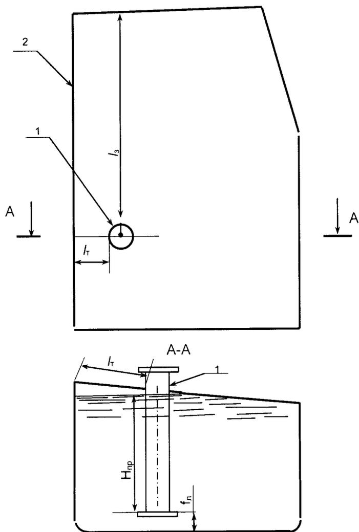
1 – измерительная труба; 2 – продольная диаметрально переборка;  $l_3$  – координата точки измерений базовой высоты танка и уровня жидкости;  $l_r$  – расстояние от продольной диаметрально переборки до образующей измерительной трубы;  $H_{гр}$  – предельный уровень градуировки танка;  $f_n$  – расстояние от дна танка до дна измерительной трубы.
