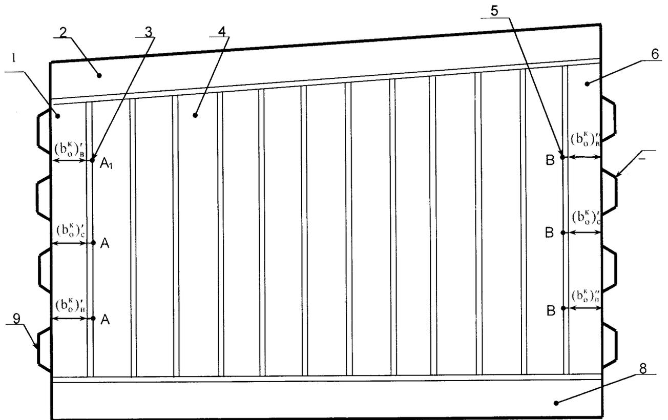
1,6-рамные шпангоуты; 2- рамный бимс; 3,5 - горизонтальные отметки; 4- полотно (вертикальные гофры) поперечной переборки; 7,9- полотна (горизонтальные гофры) продольных переборок;  $A_1, A_3, A_5$  – точки на торце полки шпангоута 1;  $B_1, B_3, B_5$  – точки на торце полки шпангоута 6;  $(b_o^k)', (b_o^k)''$  - расстояния от стенок продольных переборок до полок рамных шпангоутов 1,6.
