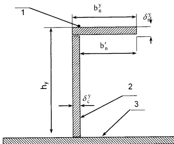
1 – полка профиля; 2 – стенка профиля; 3 – обшивка днища;  $b_n^y$  – ширина полки;  $\delta_c^y$  – толщина стенки профиля;  $h_y$  – высота стенки профиля.
