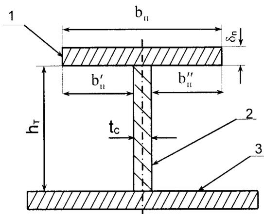
полка профиля; 2-стенка профиля; 3- присоединенный пояс обшивки;  $b_{II}, \delta_{II}$  -длина и толщина полки;  $h_{II}, t_c$  – высота и толщина стенки профиля;  $b'_{II}, b''_{II}$  - расстояние от торцов полки до стенки профиля
