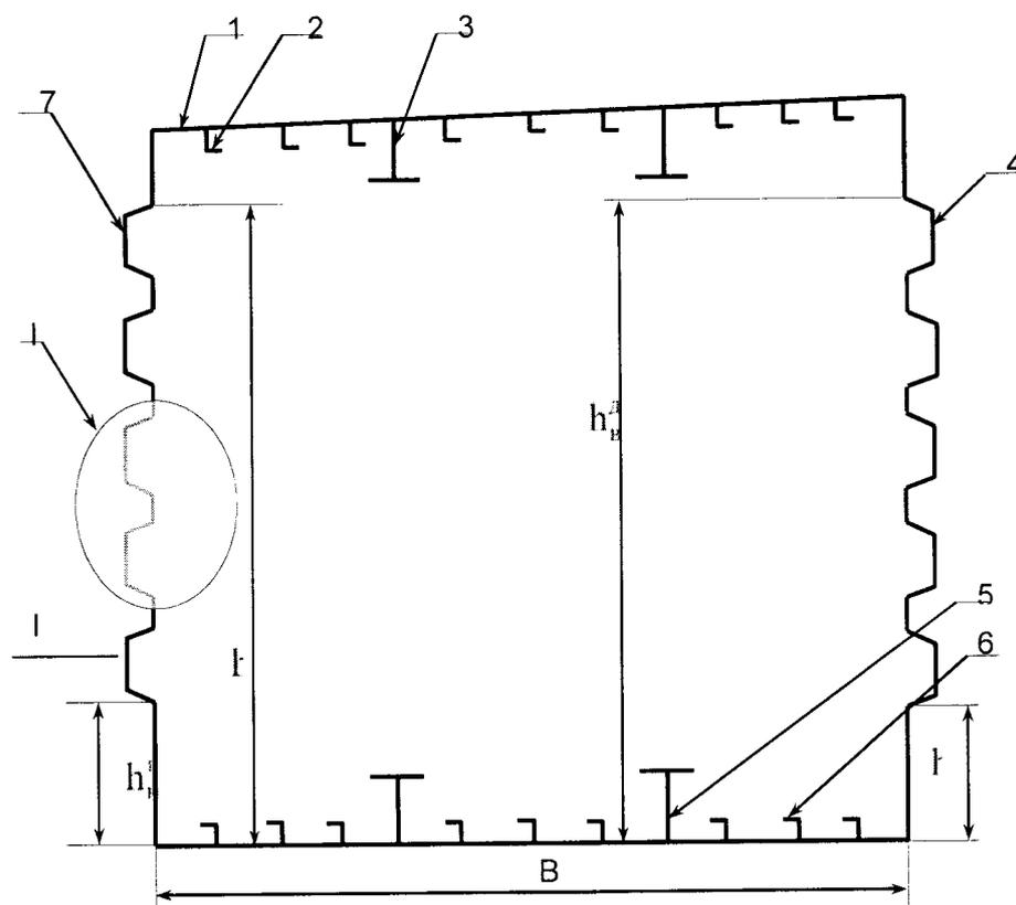
1-настил палубы судна; 2,6 –элементы силового набора уголкового профиля; 3-карлингс; 4-гофрированная продольная переборка в ДП; 5-кильсон; 7-гофриро ванная бортовая продольная переборка;  $a_r$  – ширина верхнего основания гофра;  $b_r$  – высота гофра;  $c_r$  – ширина нижнего основания гофра;  $B$ -ширина танка;  $h_n^B, h_n^D, h_n^B, h_n^D$  - нижние и верхние границы гофра.
