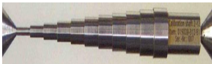
а) Мера диаметром от 2 до 12 мм и длиной 126 мм
