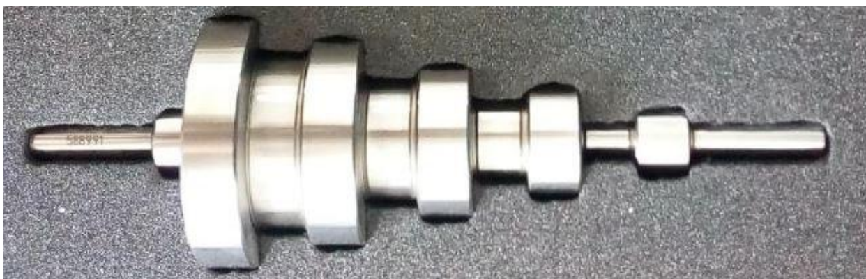
д) Мера диаметром от 8 до 48 мм и длиной 150 мм
