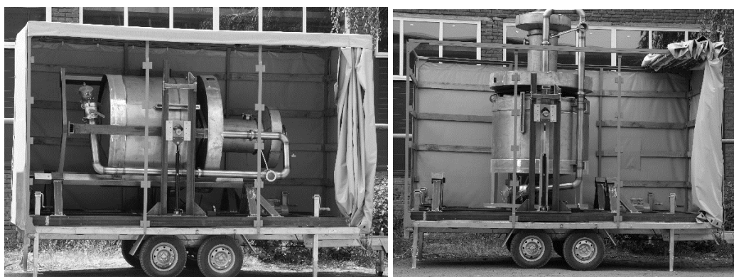
Рисунок 1 – Общий вид установок поверочных средств измерений объема и массы УПМ-2000
