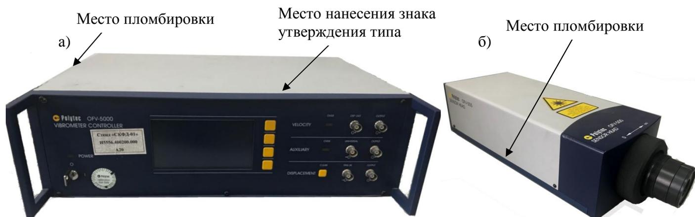
Рисунок 1 – Общий вид средства измерений, где а) контроллер OFV-5000; б) сенсорная головка OFV-505, схема пломбировки от несанкционированного доступа и место нанесения знака утверждения типа
