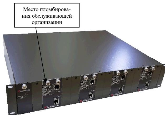
Рисунок 4 – Общий вид устройств ТЭЗ в составе шасси объединения
