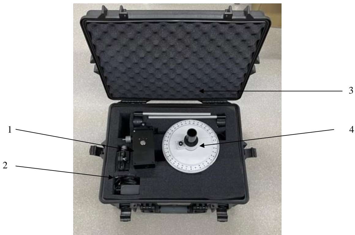
Рисунок 1 - Общий вид комплексов поверочных портативных КПП-4М 1 - раскручивающее устройство КПП-4М-1; 2 - раскручивающее устройство КПП-4М-2; 3 - кронштейны и крепежные приспособления 4 - лимб со стрелкой;
