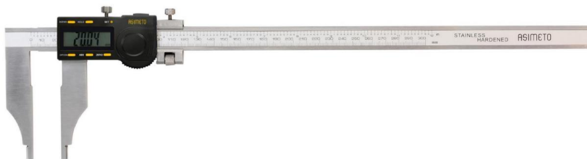
Рисунок 15 – Общий вид штангенциркулей односторонних серии 315
