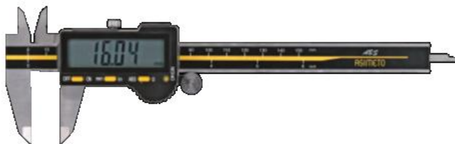
Рисунок 13 – Общий вид штангенциркулей серии 306
