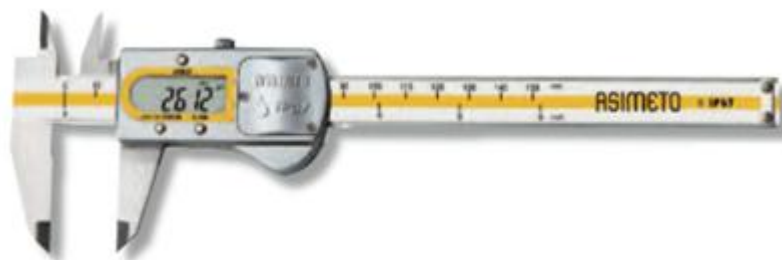
Рисунок 12 – Общий вид штангенциркулей серии 305
