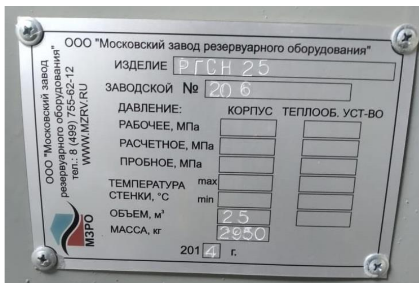
Рисунок 10 – Маркировочная табличка резервуара РГС-25, зав.№206
