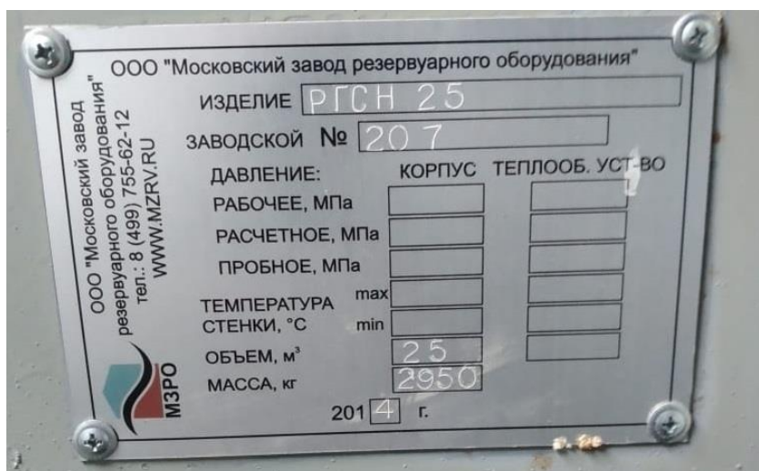
Рисунок 11 – Маркировочная табличка резервуара РГС-25, зав.№207
