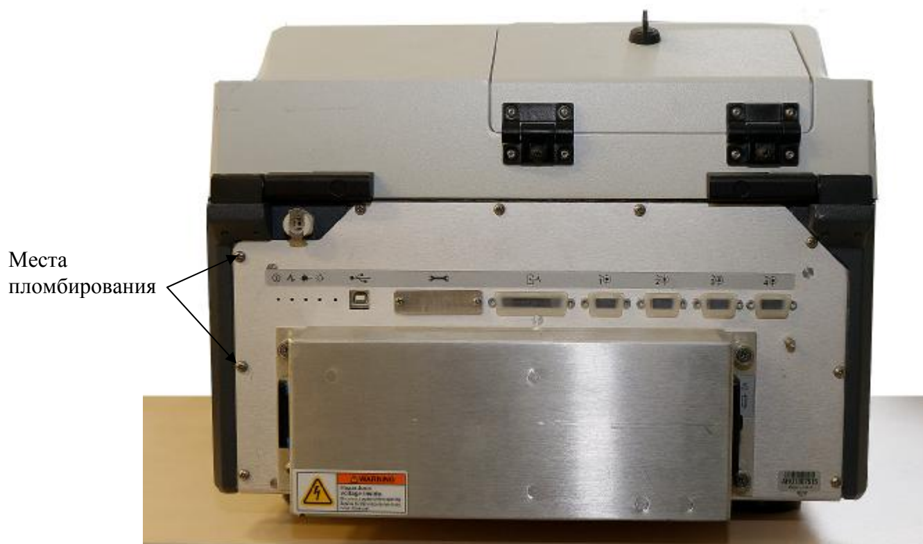
Рисунок 2 - Схема пломбировки от несанкционированного доступа
