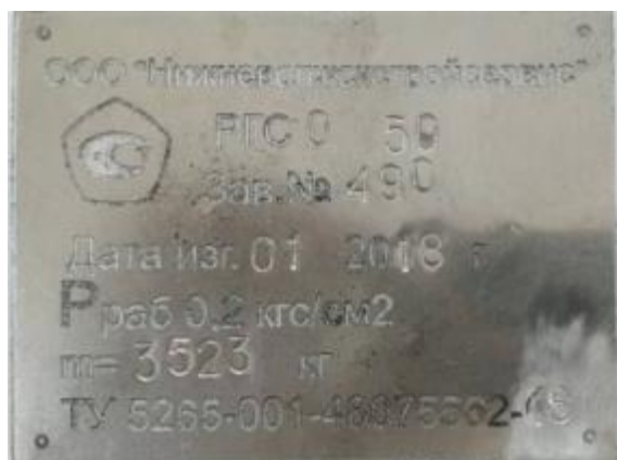
Рисунок 4 - Шильдик для резервуаров наземного исполнения
