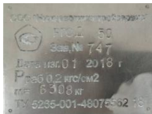
Рисунок 2 - Шильдик для резервуаров подземного исполнения
