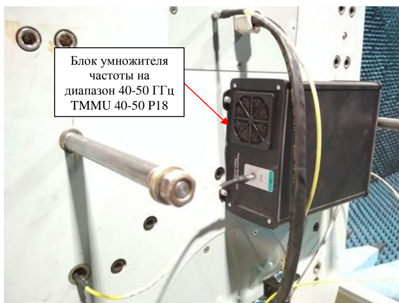
Рисунок 13 – Внешний вид блока умножителя частоты на диапазон 40-50 ГГц TMMU 40-50 P18
