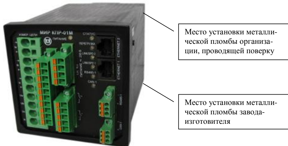
Рисунок 5 - Схема опломбировки от несанкционированного доступа модификаций КПР-01М-5(10) и КПР-01М-5(150)
