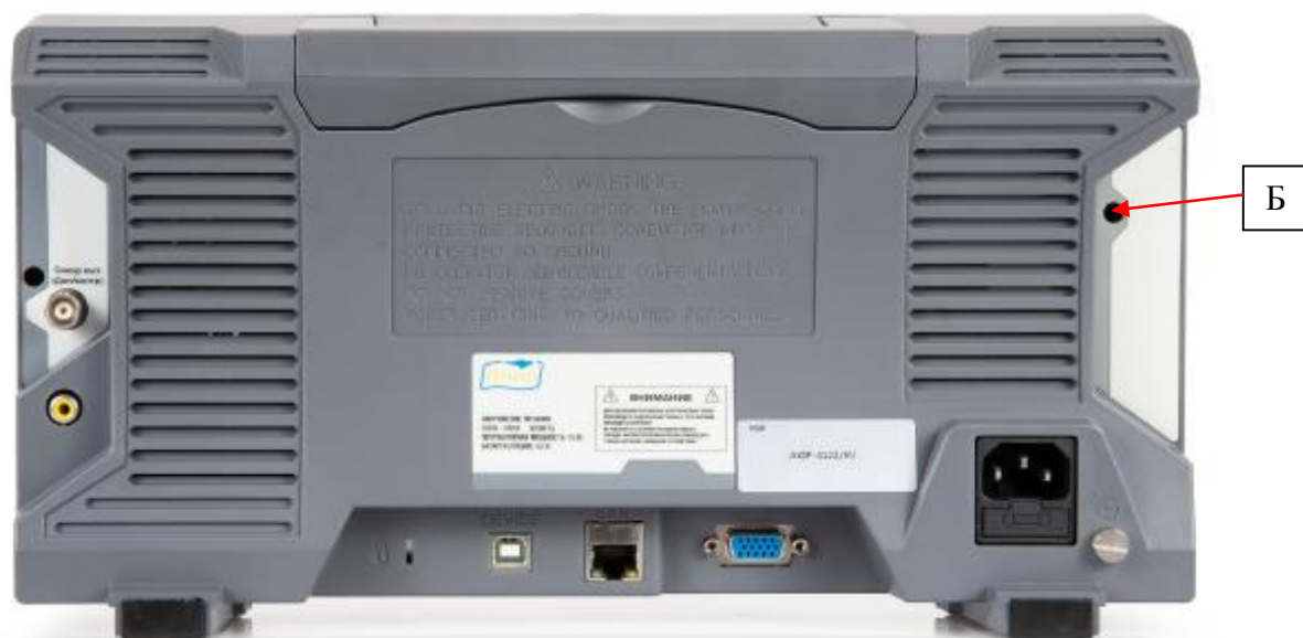
Рисунок 2 – Вид задней панели осциллографов и место пломбировки от несанкционированного доступа (Б)
