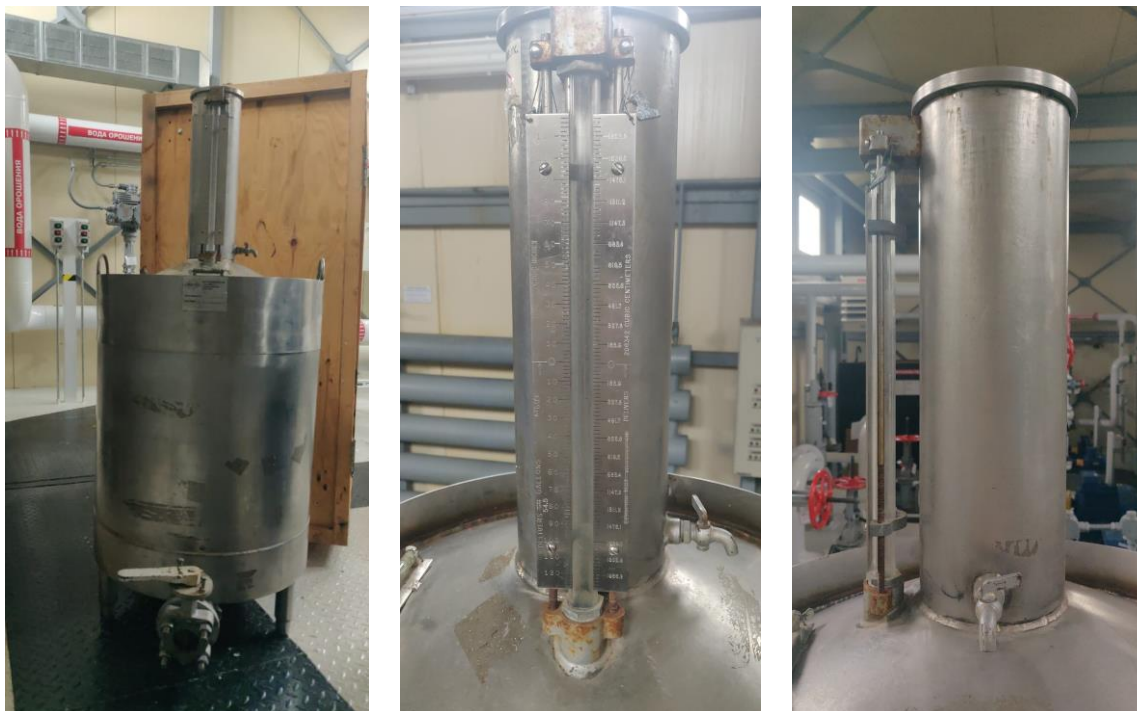
Рисунок 1 – Общий вид мерника металлического эталонного 1-го разряда
