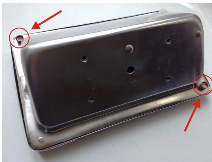
Рисунок 3 - Схема пломбировки от несанкционированного доступа
