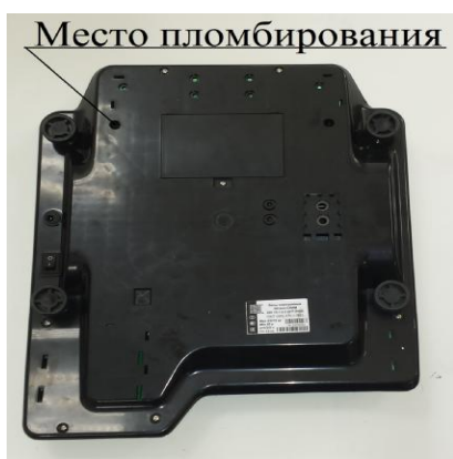
пломбировочная чашка устанавливается на днище весов (индексы: ДП6.1, ДП6.2 и ДП6.3)
