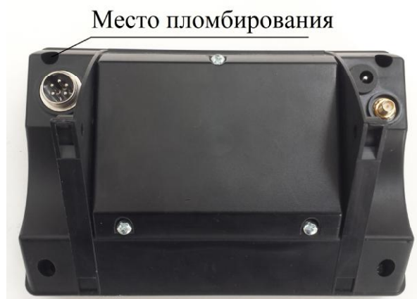
пломбировочная чашка устанавливается на задней крышке терминала (индексы: ДП3, ДП4 и ДП5)
