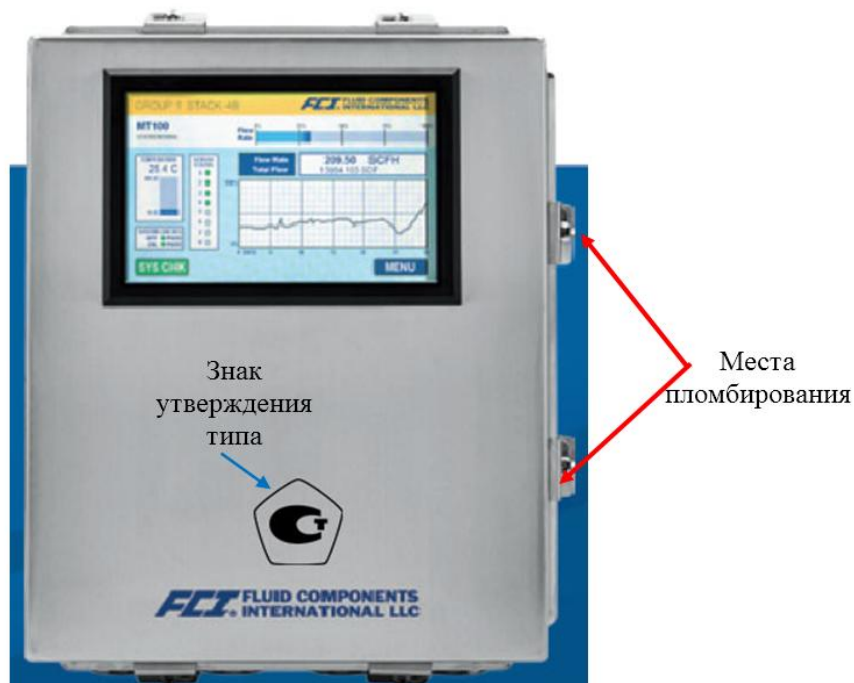
Рисунок 1 – Схема пломбирования и место нанесения знака утверждения типа вторичного преобразователя расходомера газа МТ100М
