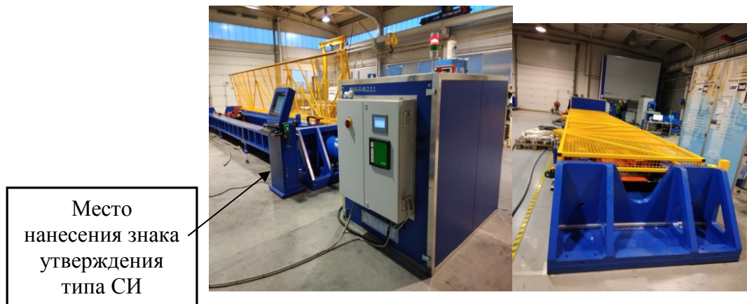
Рисунок 1 - Общий вид машины испытательной универсальной гидравлической горизонтальной LabTest 6.2000H.7
