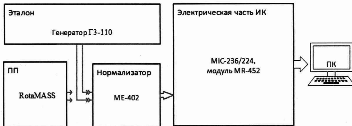
Рисунок 8 – Схема поверки ИК объемного расхода (прокачки) жидкостей
