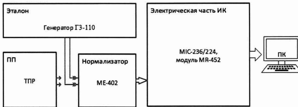
Рисунок 9 – Схема поверки ИК объемного расхода (прокачки) жидкостей
