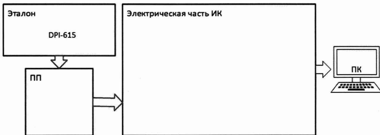
Рисунок 6 – Схема поверки ИК абсолютных, избыточных и разности давлений газообразных и жидких сред комплектным способом
