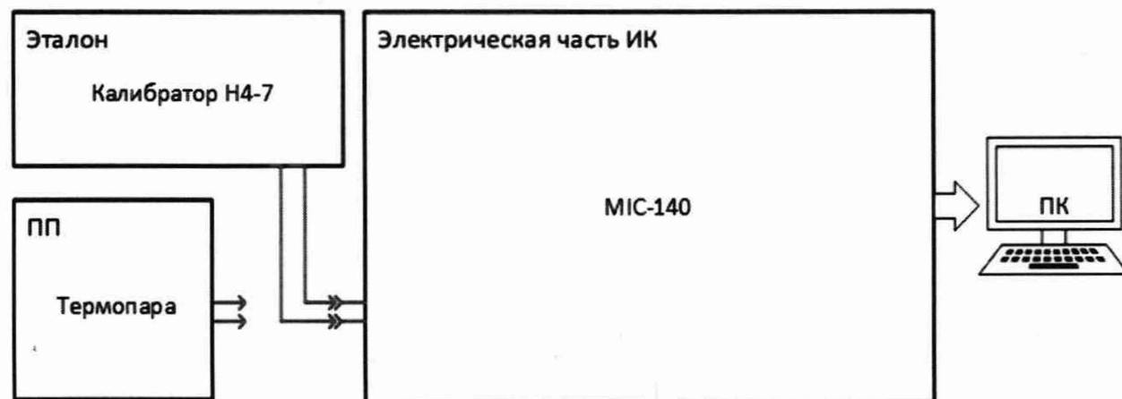
Рисунок 14 – Схема поверки ИК сигналов от датчиков температуры (ТЭДС термопар, соответствующих температуре)
