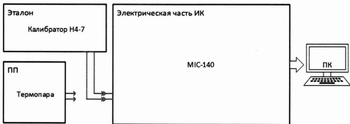
Рисунок 3 – Схема поверки ИК температуры жидких и газообразных сред (с ПП – термоэлектрическим преобразователем) поэлементным способом
