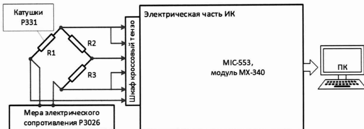
Рисунок 16 – Схема поверки ИК относительного напряжения тензодатчиков
