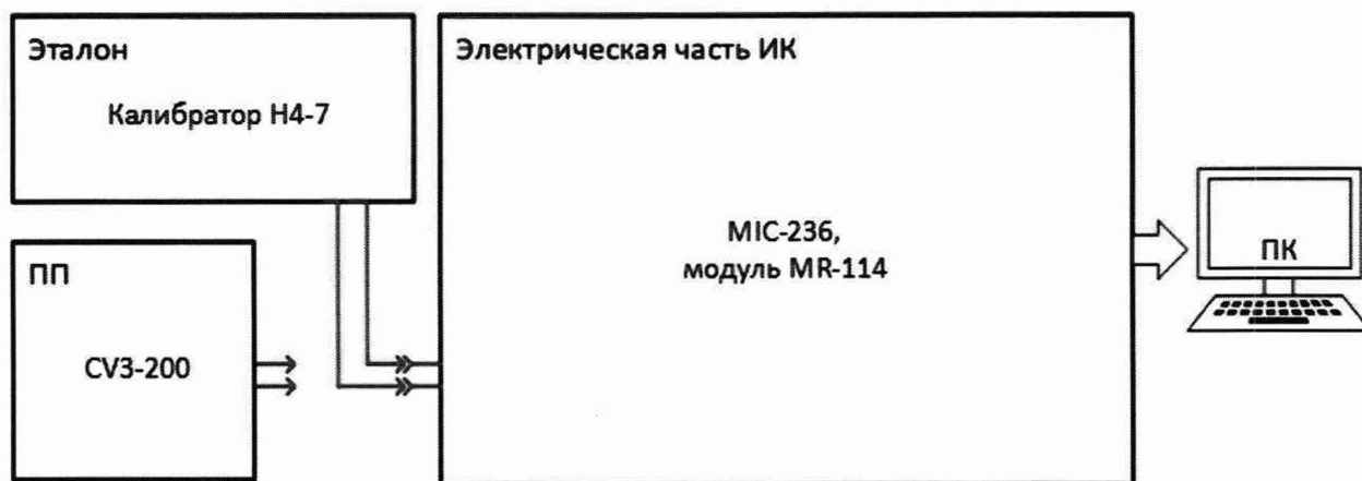
Рисунок 10 – Схема поверки электрической части ИК напряжения переменного тока генератора
