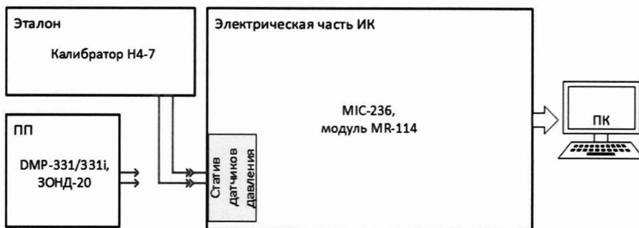
Рисунок 5 – Схема поверки ИК абсолютных, избыточных и разности давлений газообразных и жидких сред поэлементным способом
