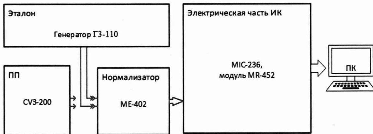
Рисунок 13 – Схема поверки ИК частоты переменного тока
