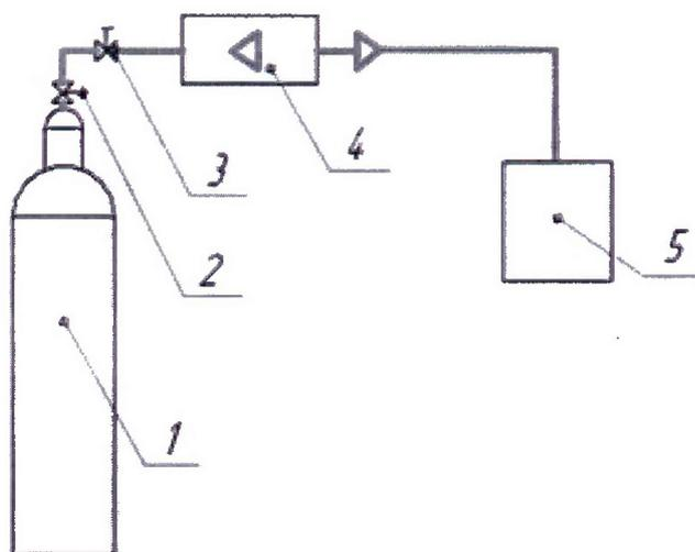
1 – баллон с ПГС; 2 – вентиль; 3 – вентиль точной регулировки;
