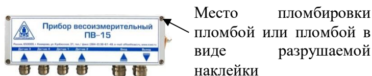
Рисунок 2 – Схема пломбировки весов от несанкционированного доступа прибора
