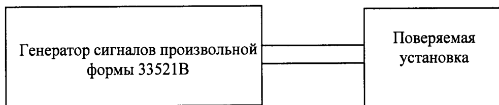
Рисунок 3 – Структурная схема определения абсолютной погрешности измерений временных интервалов
