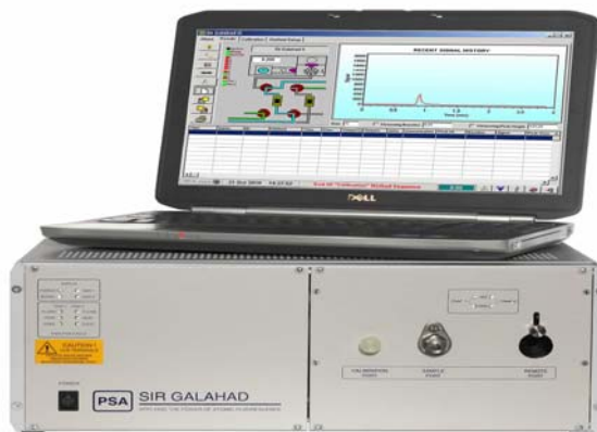
Рисунок 1 - Общий вид анализатора ртути «SIR GALAHAD II» PSA 10.525 в лабораторном исполнении
