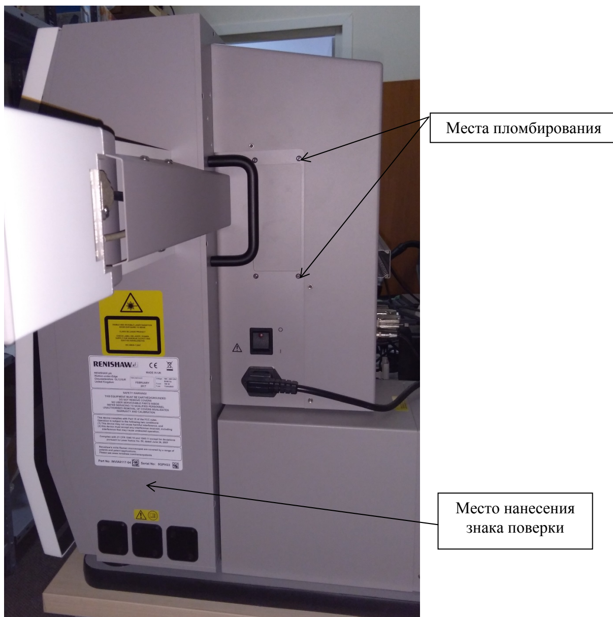
Рисунок 2 - Схема пломбировки от несанкционированного доступа, обозначение места нанесения знака поверки
