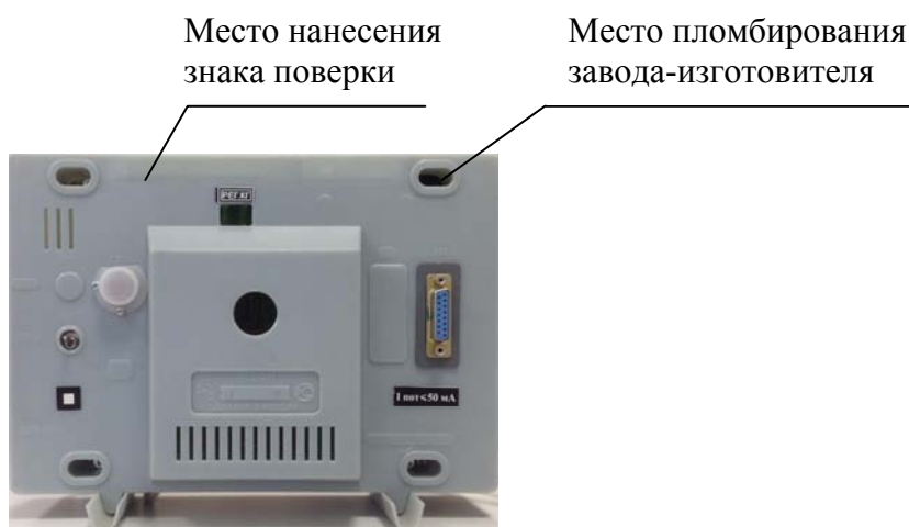
Рисунок 2 - Схема пломбировки от несанкционированного доступа
