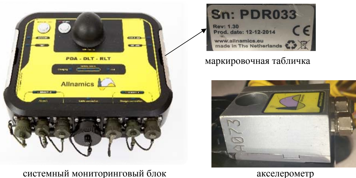
Рисунок 1 - Общий вид систем мониторинга погружения свай
