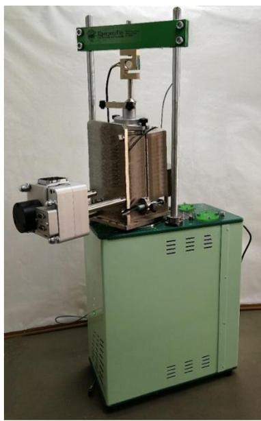
Рисунок 3 - Общий вид устройства для исследования образцов грунта ЛИГА модификации КЛЮС с применением срезовой/сдвиговой каретки
