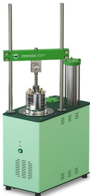
Рисунок 9 - Общий вид устройства для исследования образцов грунта ЛИГА модификации КЛ1С с применением компрессионного одометра с одним волюмометром
