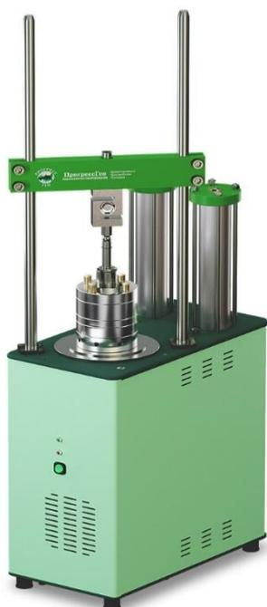
Рисунок 7 - Общий вид устройства для исследования образцов грунта ЛИГА модификации КЛ1 с применением компрессионного одометра с двумя волюмометрами
