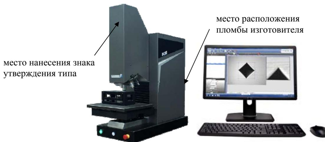
Рисунок 2 - Внешний вид твердомеров KV 50 SR
