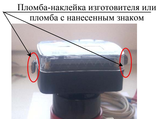
Рисунок 2 - Схема пломбировки теплосчетчиков
