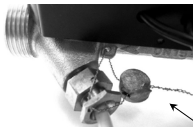
Пломба изготовителя или пломба с нанесенным знаком поверки или пломба организации, установившей теплосчетчик
